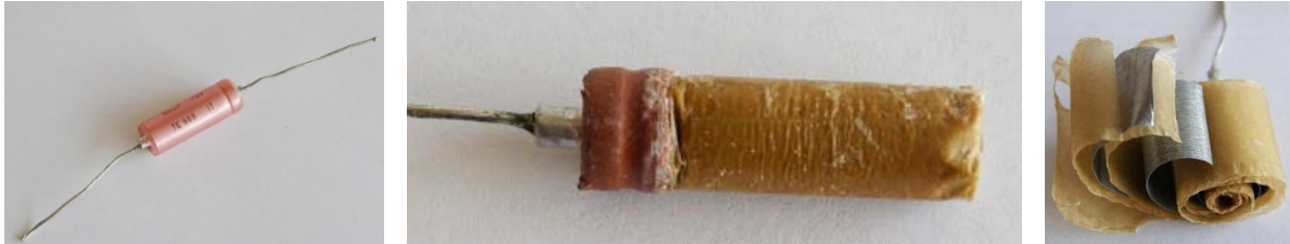
Obr. B3.1. Původní svitkový kondenzátor (vlevo), po sundání kovového obalu (uprostřed) a po rozbalení (vpravo) – jsou vidět dvě vodivé vrstvy oddělené papírem.
