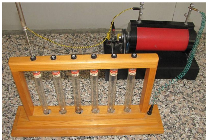
Připojení sady výbojových trubíc se vzduchem různého tlaku ( http://ara.karlov.mff.cuni.cz:8080/mediawiki/index.php/10.45_Crookesova_trubice )
