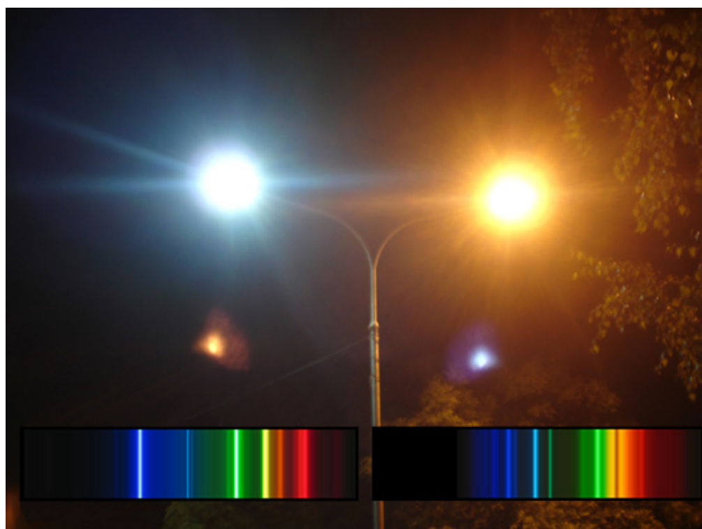
Obr. Dvojitá lampa osazená rtuťovou i (vysokotlakou) sodíkovou výbojkou a jejich spektra. (Foto: Pavel Nesét, spektra: Jan Martiš, http://www.vybojky-zarovky.cz/text26.html )
