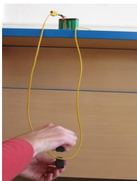
Obr. 1. Uspořádání experimentu – vodič a magnety
