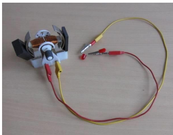
Obr. 10 Dioda zapojená ke generátoru s komutátorem
