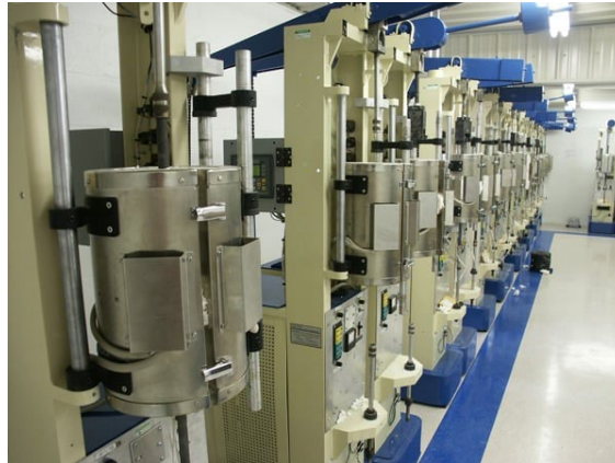
Obr. 5. Laboratoř pro měření creepu bývá vybavena řadou „creepostrojů“.
