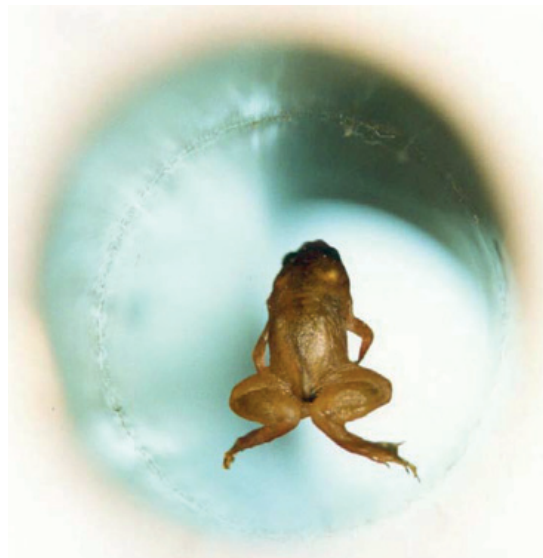
Obr. 1 Okamžiky levitace v Nijmegenu. Nahoře: Vodní koule (o průměru asi 5 cm) se volně vznáší uvnitř vertikální dutiny v elektromagnetu. Dole: Žába, která se naučila létat. Tento obrázek stále slouží jako symbol ukazující, že magnetismus „nemagnetických věcí“, včetně lidí, není tak zanedbatelný. Za tento experiment jsme spolu s Michaelem Berrym dostali v roce 2000 Ig-Nobelovu cenu 3 . Nejdříve se nás zeptali, zda se odvážíme tuto cenu přijmout, a já jsem hrdý na náš smysl pro humor a skromnost, že jsme souhlasili.
