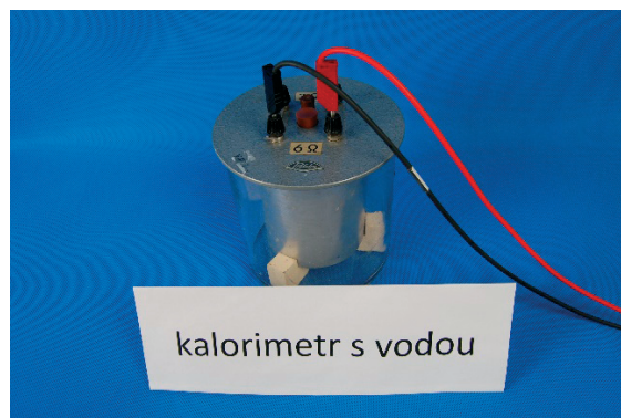
Obrázek 5: Školní kalorimetr vyhříváný rezistorem.
